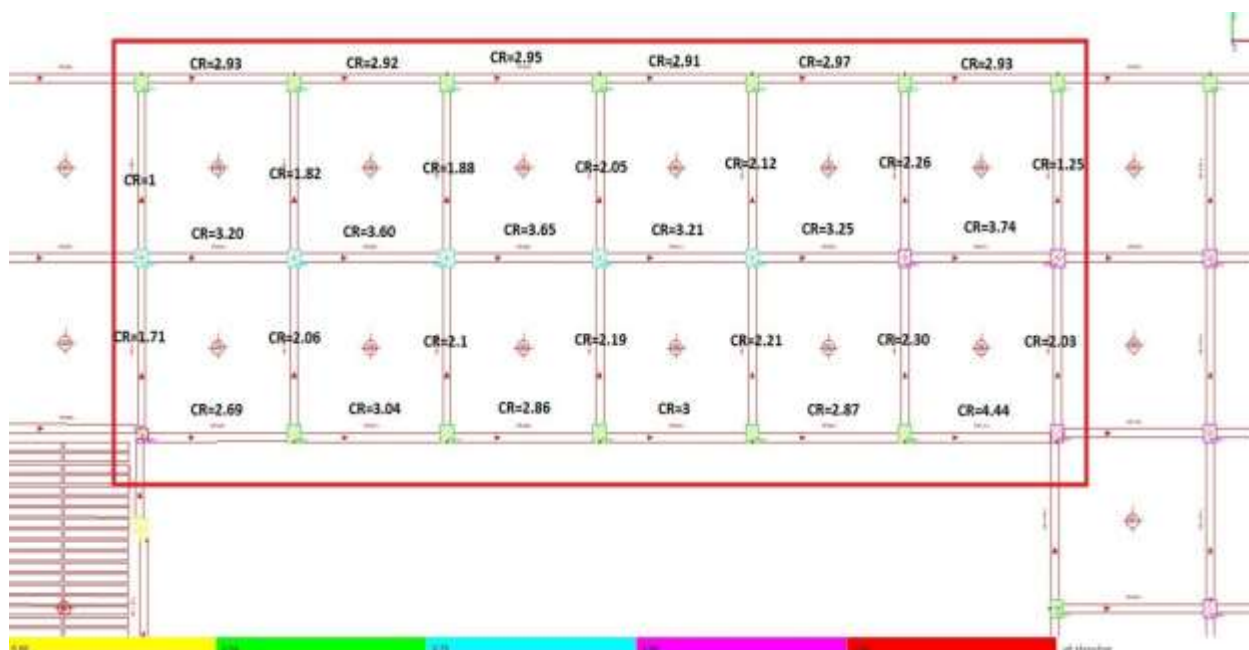
Εικόνα 88 – Ανεπάρκειες δοκών τμήμα 3 ου ορόφου με δέσμες ράβδων ΕΚΩΣ – ΚΤΙΙ
